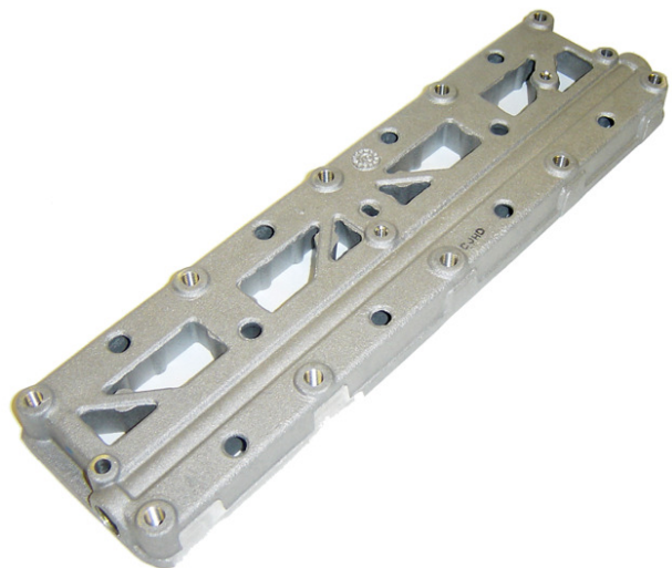
Abb 2. Die verbesserte Motorblockverstärkung.
